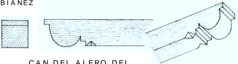
CAN DEL ALERO DEL TEJADO
