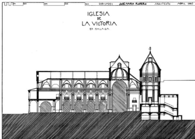
Figura 2. Iglesia de la Victoria de Málaga. Sección longitudinal.
