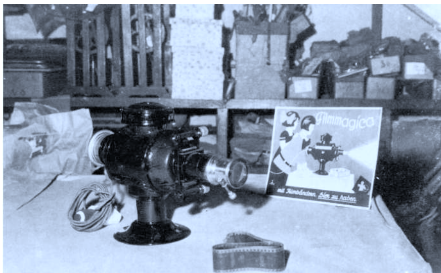
Linterna mágica eléctrica utilizada por San Gregorio. Este modelo permitía la proyección de bandas de celuloide perforadas.
