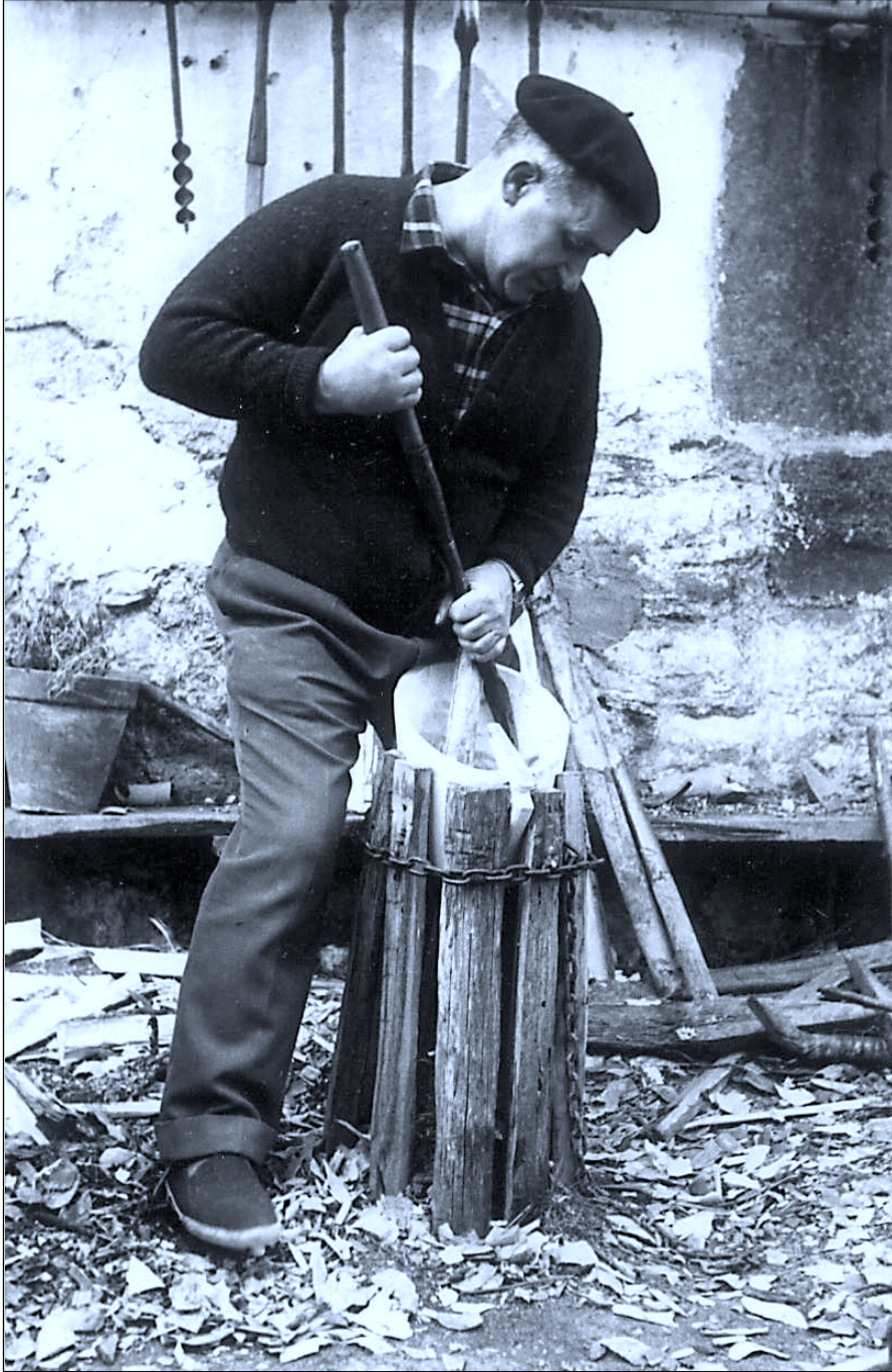
El artesano, manipulando la errakia , ensancha el vaciado iniciado con la taratulia .
