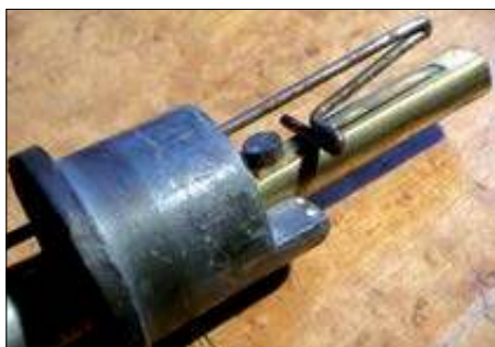
Fig. 37. Detalle de un tubo de lengüeta libre.
