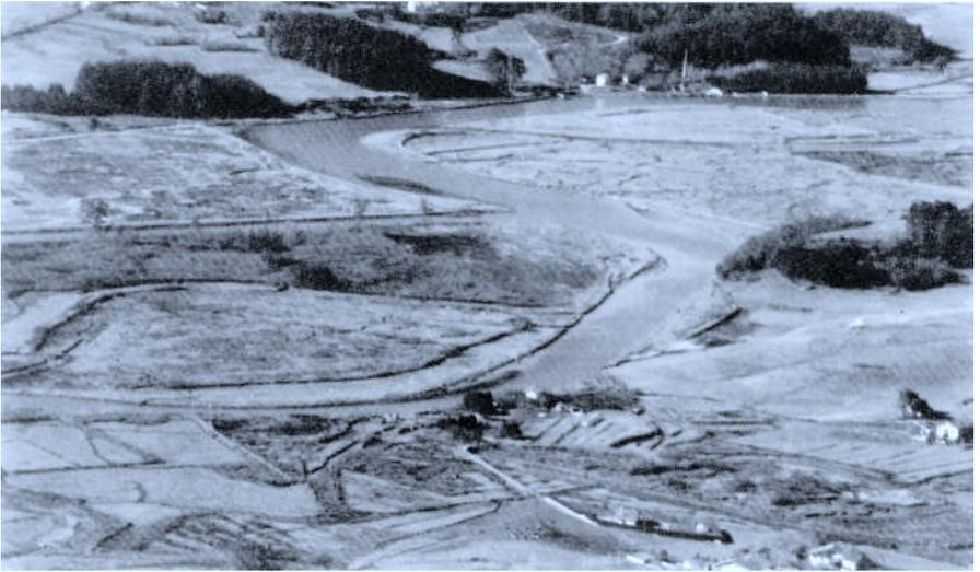
Foto 4. Canales o esteros principales de la marisma alta. El sistema de flujo del agua es completado con más canales secundarios de drenaje.
