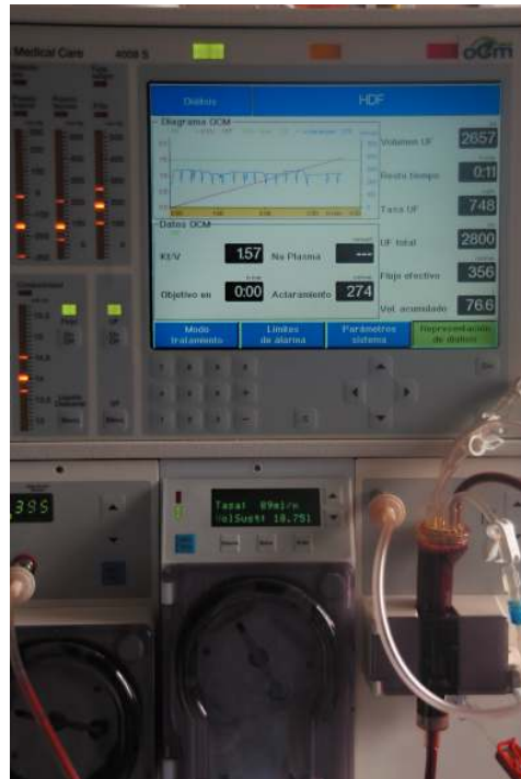
Foto 1. Monitor / Módulo. Datos de HDF - ON-LINE y aclaramiento.
