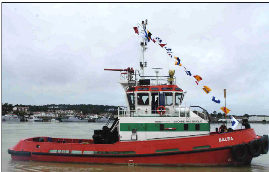
Fig. 14. Le BALEA, nouveau remorqueur de la CCI de Bayonne Pays Basque équipé contre l'incendie.
