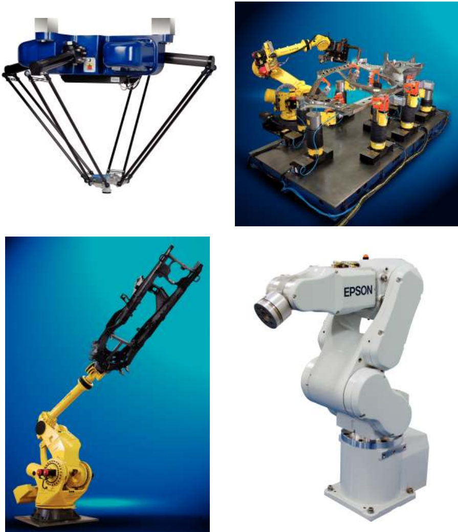
Fig. 3. a) Esempi di robot industrial a struttura antropomorfa e ad architettura parallela.
