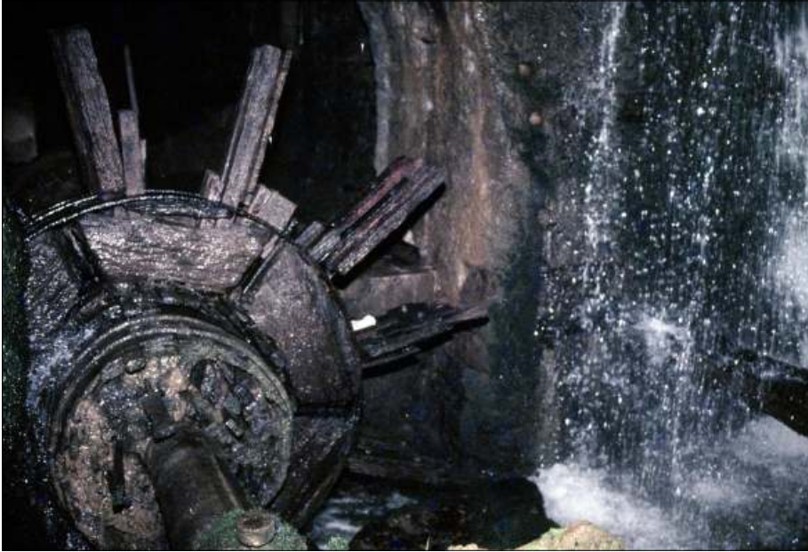
Detalle de la gran rueda de madera que es movida por el agua en el interior de la ferrería, construida a comienzos del siglo XVI y que cesó su actividad en 1952 (Foto: Antxon Aguirre Sorondo. Marzo, 1982. www.3digitala.com ).
