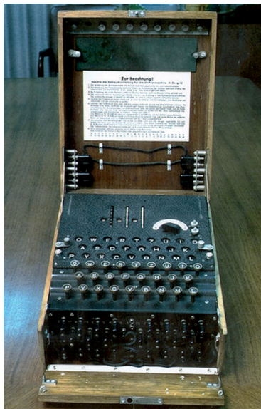
Máquina Enigma, máquina electromecánica de cifrado rotativo utilizado por el ejército alemán durante la segunda guerra mundial, y así como por el bando Nacional durante la Guerra Civil Española. Gracias al esfuerzo de los matemáticos Marian Rejewski y Alan Turing se consiguió romper enigma. https://commons.wikimedia.org/wiki/File:Enigma.jpg
