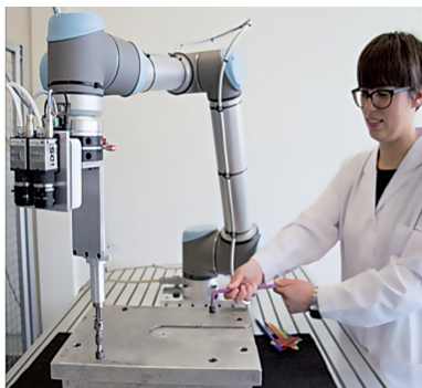
9. irudia. Elkarlaneko robotika adibidea UR (Universal Robot) fabrikatzailearen robot batekin
