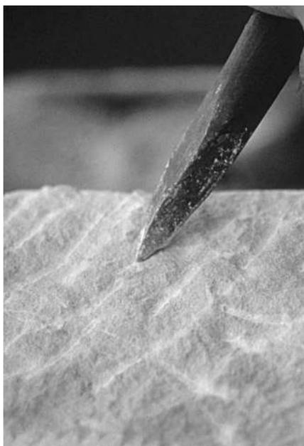
Fig. 12. Elaboración de la pieza 1, detalle del desbaste con punzón y marcas del mismo.
