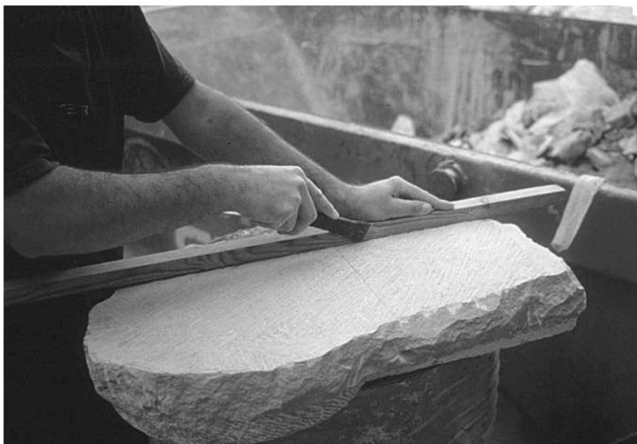
Fig. 10. Elaboración de la pieza 1. Marcado de ejes para delimitar lados de la pieza mediante regla y punzón.
