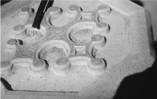
Fig. 24. Elaboración de la pieza 2. Detalle del vaciado del interior de la pieza.
