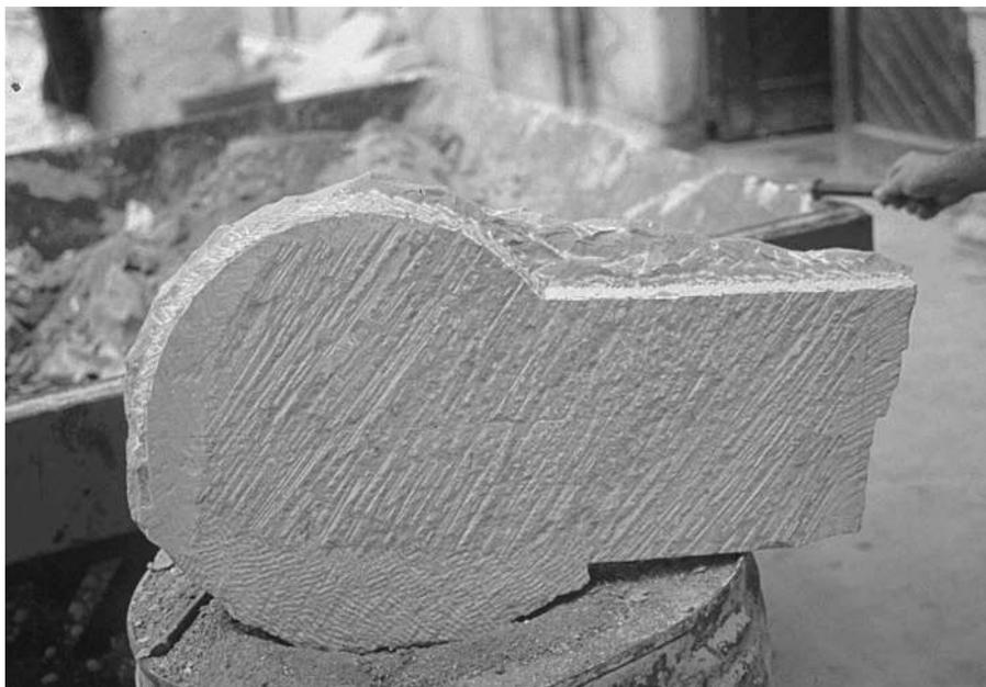
Fig. 13. Elaboración de la pieza 1. Vista de la pieza a medio elaborar. Se observa en el paramento, la marca del trinchante y la gradina. En el perfil, a medio desbastar se observa el uso de cincel y punzón.
