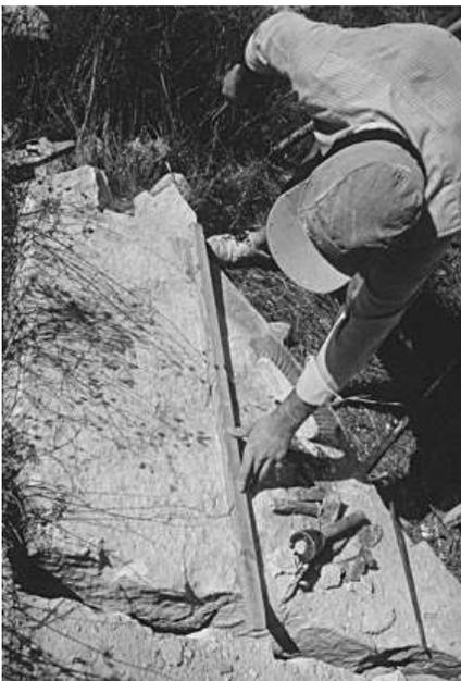
Fig. 3. Marcado de la línea de fractura con la regla.
