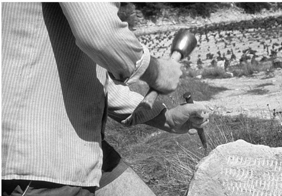
Fig. 9. Desbaste de la pieza mediante punzón.
