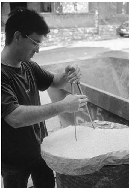
Fig. 11. Elaboración de la pieza. Marcado del contorno del disco mediante compás.
