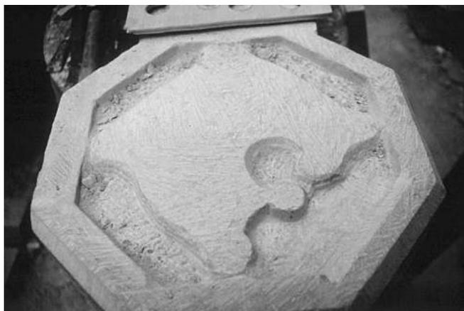
Fig. 23. Elaboración de la pieza 2. Rebajado de la figura de la cara a; primeramente se trabaja la fisonomía de la decoración.
