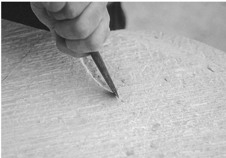
Fig. 17. Elaboración de la pieza 1. Inicio del rebaje de la decoración; contorneado mediante el cincel.
