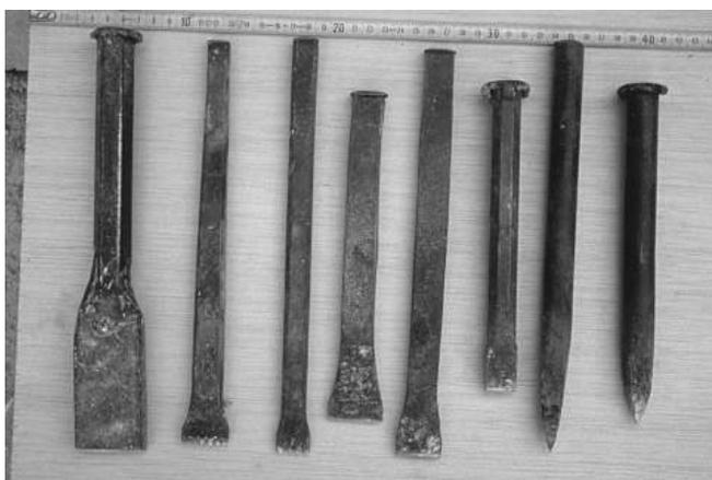
Fig. 29. Diferentes herramientas utilizadas (de izquierda a derecha): topo, gradina (2), cincel (3), punzón (2).
