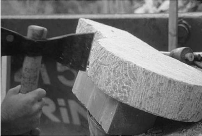
Fig. 14. Elaboración de la pieza 1. Afinado del perfil con trinchante.
