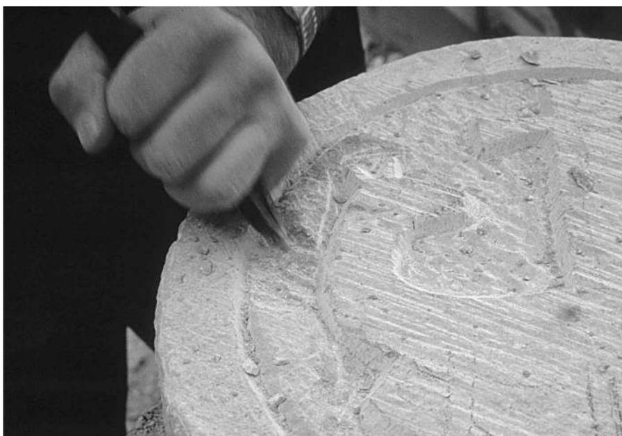
Fig. 18. Elaboración de la pieza 1. Decoración de la cara b; rebajado mediante punzón.
