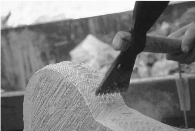
Fig. 15. Elaboración de la pieza 1. Afinado del perfil con trinchante y dientes.
