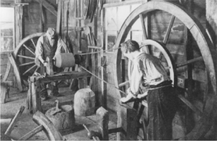
2. TORNO DE VAIVEN . Accionado por un auxiliar (el artesano se dedica exclusivamente al torneado; discontinuo). (Urdangarin, Carmelo y Aldabaldetrecu, Francisco. op.cit ).
