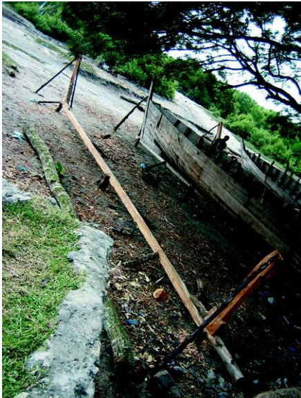
Fig. 11. Colocación de quilla, roda y codaste.
