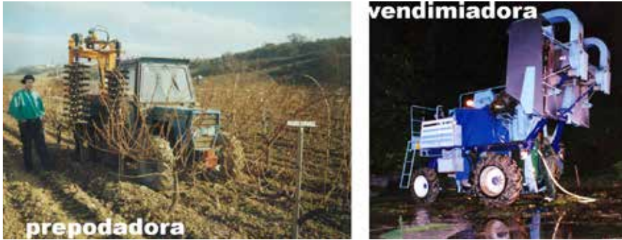
Figura 17. Maquinaria para vid en espaldera.
