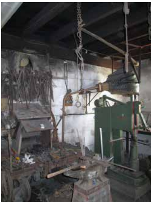
Fig. 3: forge de J. Larralde: foyer, enclume avec marteau et système à faire des rivets; sur la hotte les pinces; le soufflet et le système permettant de l'actionner, la servante.
