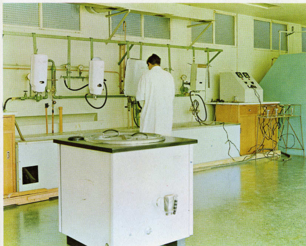
En este laboratorio, los fabricados FAGOR son sometidos a un minucioso control. En la fotografía, un aspecto de la comprobación de calentadores y marmitas industriales.
